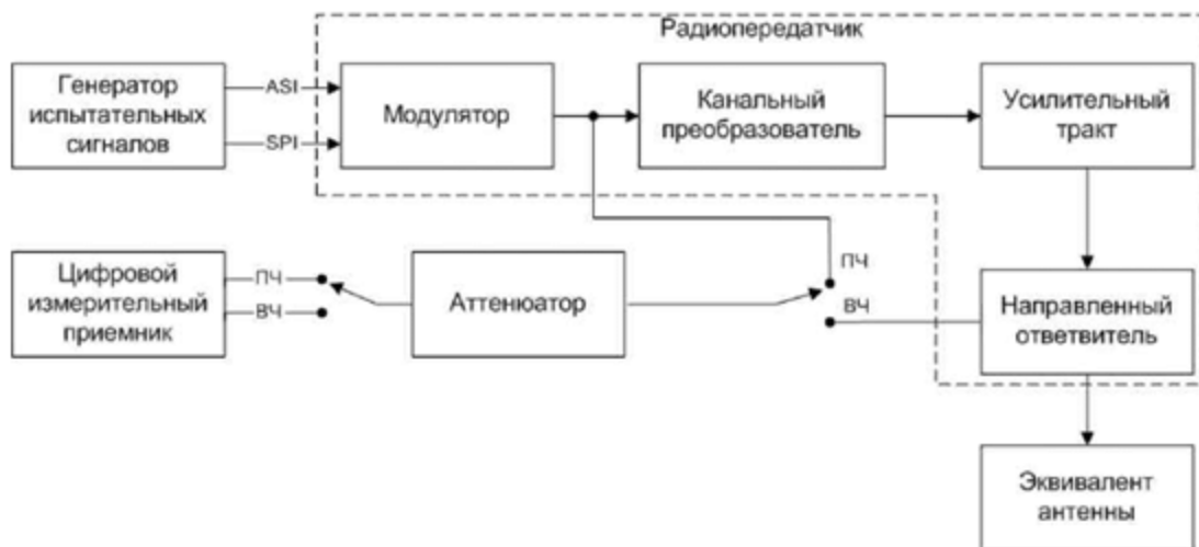
Рисунок 5.3.2.2. Схема измерения эквивалентных шумовых потерь усилительного тракта радиопередатчика
