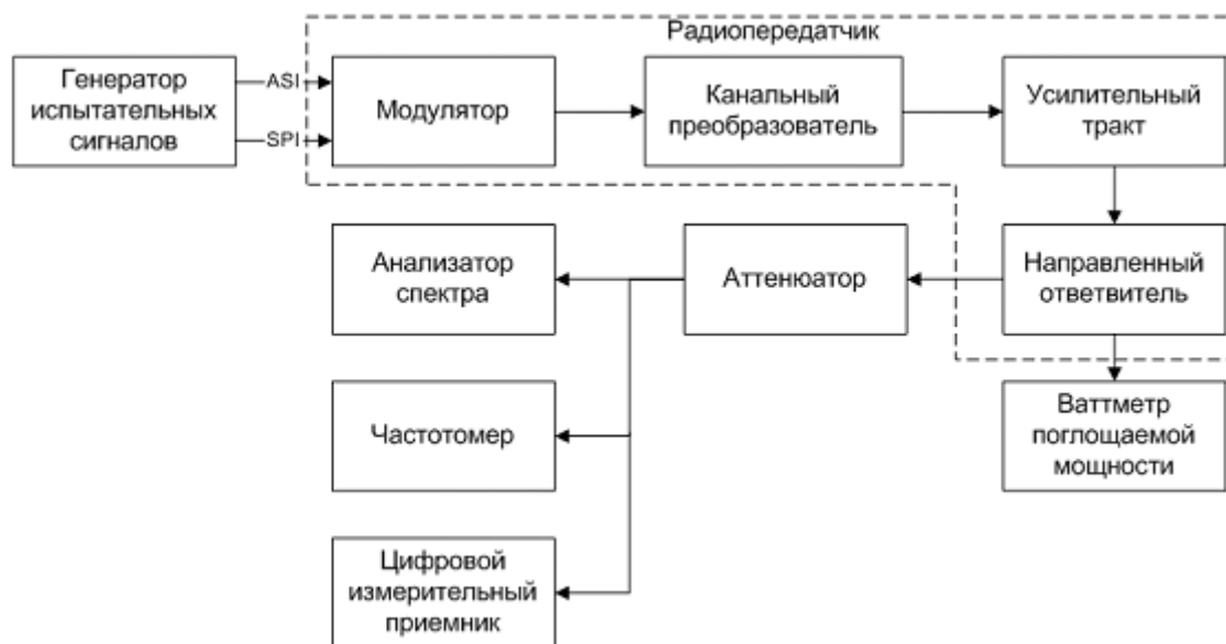
Рисунок 5.3.2.1. Схема измерения основных параметров радиопередатчиков
